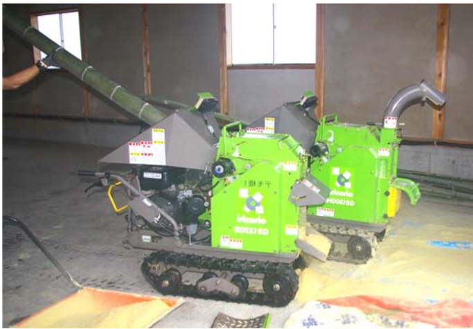
市内でチップのデモ機による竹の粉砕実演。枝葉の付いたままの竹を入れると瞬間に竹粉ができた(6月16日、市内水町)。
