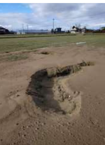
液状化で吹き出した砂が田面を覆い、田に大きな穴が=正得地区
